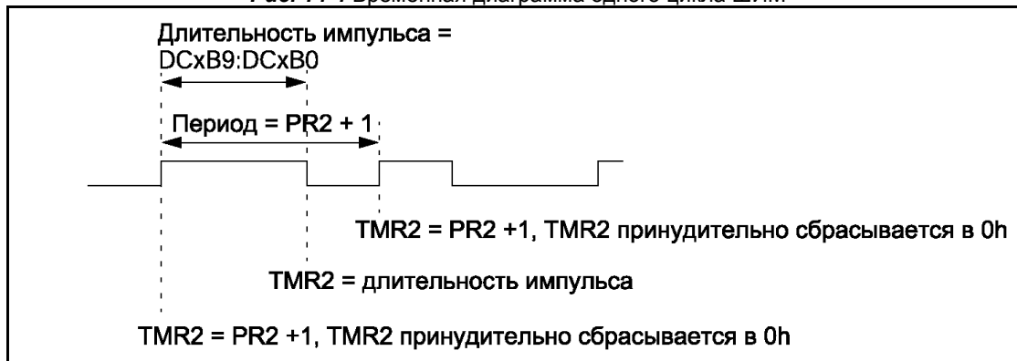
Рис. 14-4 Временная диаграмма одного цикла ШИМ
